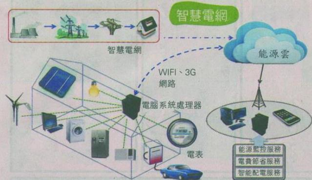
▲智慧家電會將感測器感測到的資訊傳到雲端，可以讓使用者知道能源使用的情形，進而節省電費、智能配電。
